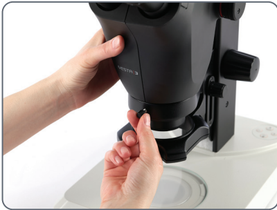
Optical carrier: 76 mm (standard)
